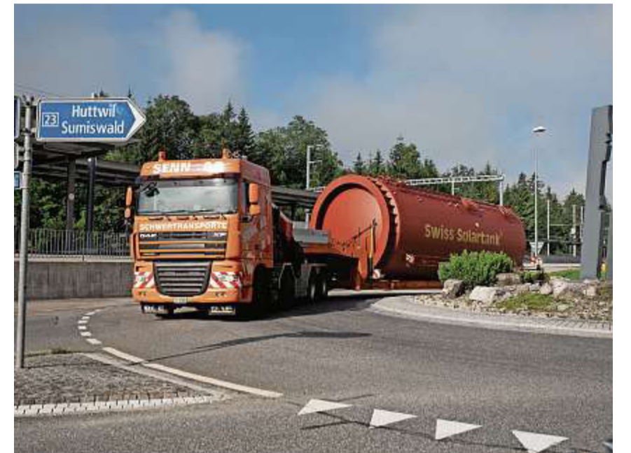
Mit einem Spezialfahrzeug wurde der 12-Tonnen-Wasserspeicher nach Huttwil transportiert.
